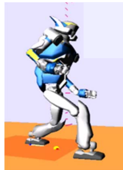
Réalisation d'un grand pas avec HRP-2 en utilisant toute la dynamique
