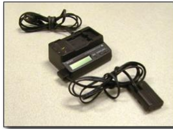
Figure 74 : Subcam « AV batteries chargeur, adaptateur et câbles »
